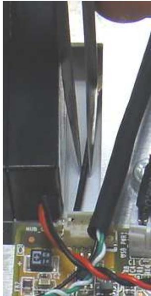
RFID天線LCD BRACKET底穿進，由SPEAKER孔位穿出，需用尖嘴夾子取出天線。
